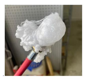
Obwohl die Gründe dafür nicht zu 100 % geklärt sind, kann dieses Phänomen aufgrund von Feuchtigkeit und hohen Temperaturen auftreten, z. B. wenn Gasflaschen direktem Sonnenlicht ausgesetzt sind oder ein undichtes Druckventil haben.
